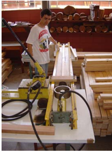
Figura 9 – Prensagem da lâmina para colagem
