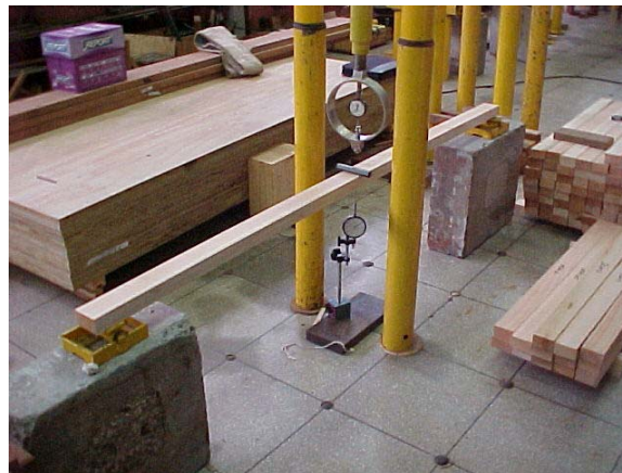
Figura 5 – Esquema do Ensaio de Flexão Estática
