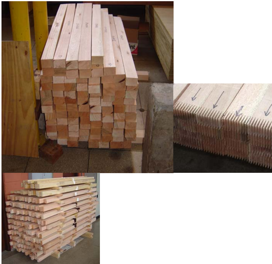
Figura 8 – Peça aplainada, peça entalhada e peça emendada
