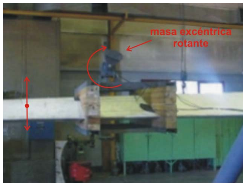
Figura 7: Ensayo de fatiga a plena escala. Sistema excitador montado sobre la pala.
