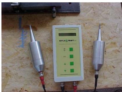
Figura D – Equipamento de ultra-som e desenvolvimento da classificação mecânica por emissão ultra-sônica.
