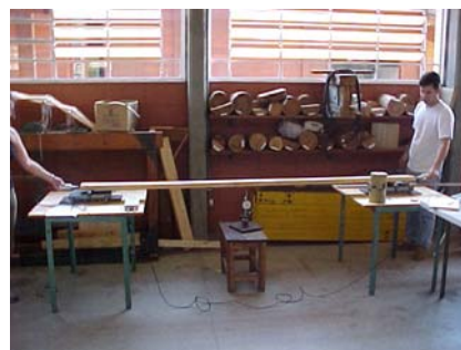
Figura D – Equipamento de ultra-som e desenvolvimento da classificação mecânica por emissão ultra-sônica.
