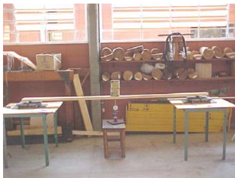
Figura C – Teste de flexão estática em relação ao eixo de menor inércia das pranchas.
