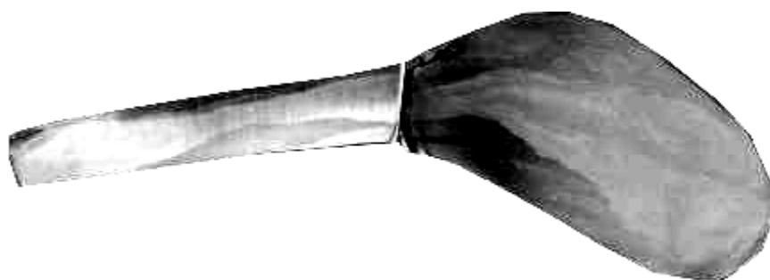
Figura 6. Macroestrutura da haste femoral forjada antes do acabamento.
