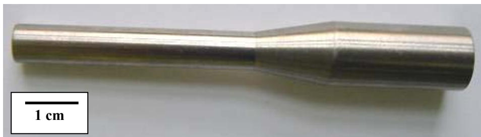
Figura 1. Detalhes do corpo de prova após usinagem e pronto para o forjamento.
