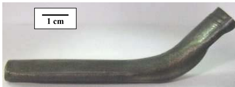
Figura 2. Detalhes do corpo de prova após o dobramento a quente.
