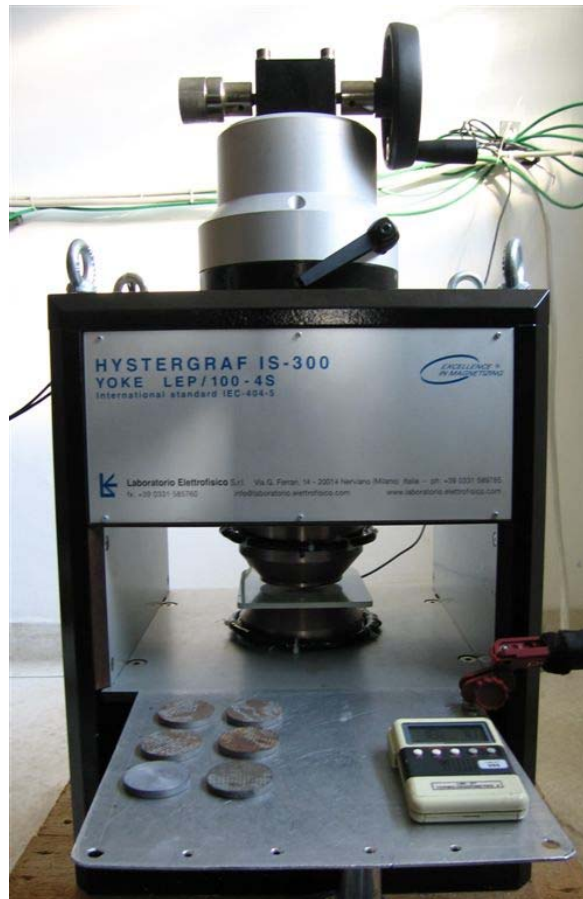
Figura 1: Detalhes do histeresígrafo: eletroímã e bobinas de pick-up entre as peças polares.
