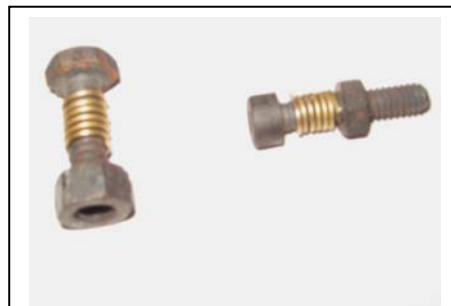
Figura 1: Molas de CZA conformadas ao redor de parafusos de 4,0 e 6,0 mm.
