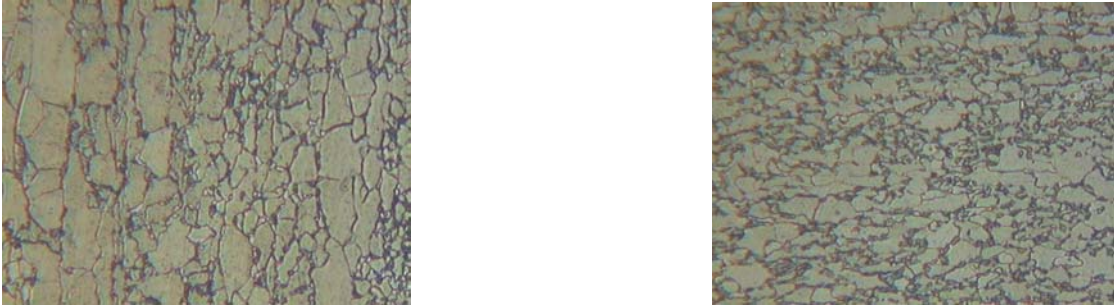
Figura 1: Metalografias obtidas após processamento metalográfico e utilização do reagente de Le Pera.
