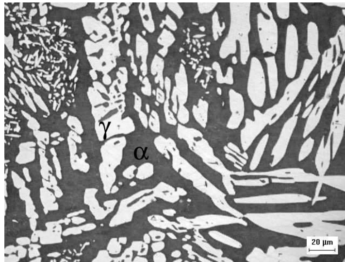
Figura 1. (a), Microestrutura austenita ( \gamma ) e ferrita ( \alpha ) do aço Duplex sem Nb. Ataque químico: Behara.
