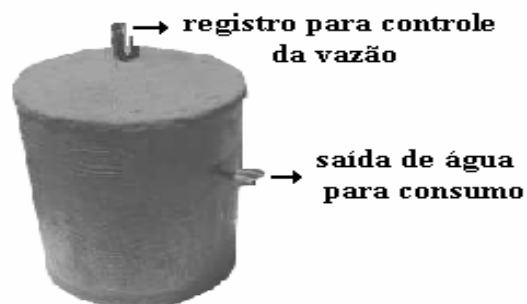
Figura 2 – Armazenador térmico alternativo construído em fibra de vidro.
