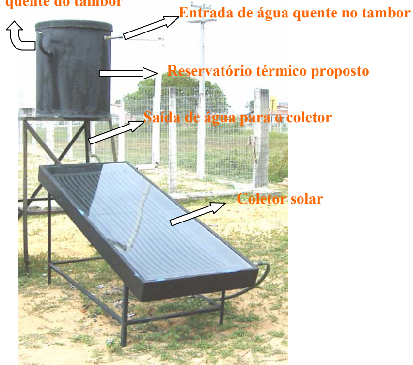
Figura 3 – Sistema de aquecimento composto pelo coletor e reservatório térmico.
