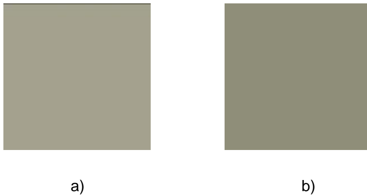
Figura 5– Cores dos pigmentos calcinados a 800 °C das perovskitas a)LaCrG e b) LaCrC
