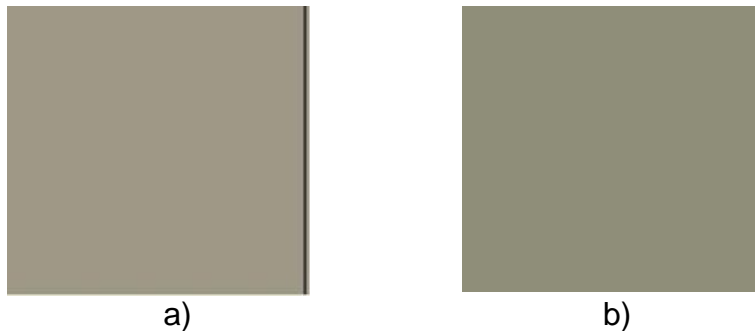
Figuras 6 – Cores dos pigmentos calcinados a 1000 °C das perovskitas a)LaCrG e b) LaCrC
