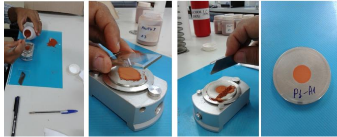
Fig.2. Compactação da amostra para análise de difração de raios-X.
