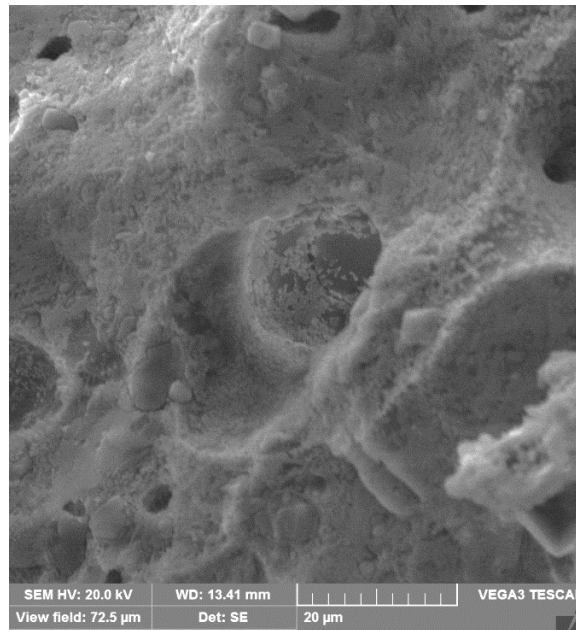
Figura 12 – Micrografia da formulação cerâmica A2 sinterizada a 1100°C.
