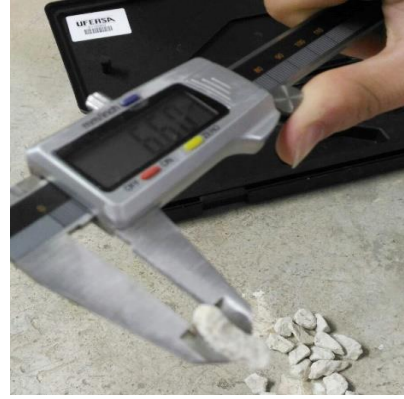
Figura 2 – Determinação da espessura da brita.
