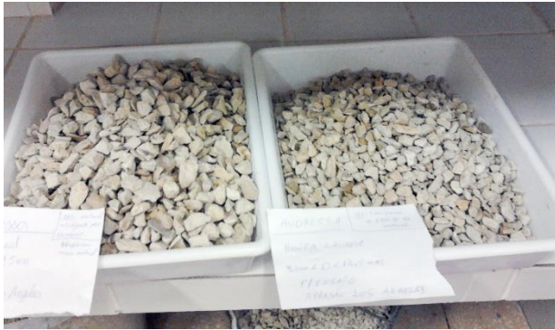
Figura 3 – Frações de material para ensaio de abrasão.
