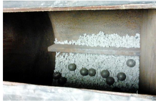
Figura 4 – Amostra e carga abrasiva inseridos no tambor da máquina Los Angeles.
