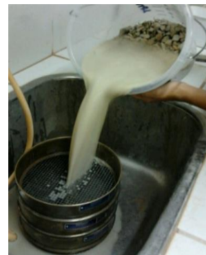
Figura 6 – Água de lavagem vertida sobre peneiras para determinação do teor de material pulverulento.
