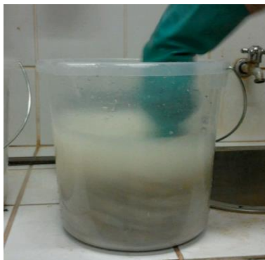
Figura 5 – Agitação da amostra para provocar suspensão do material pulverulento.
