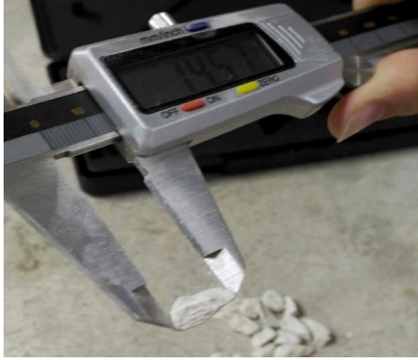
Figura 1 – Determinação do comprimento da brita.
