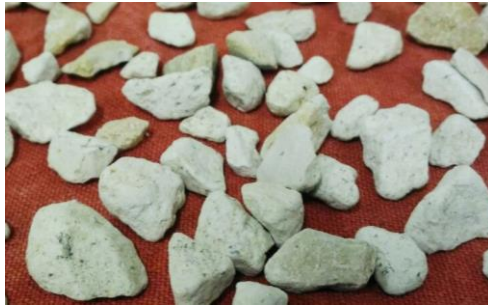
Figura 7 – Aparência dos grãos após realização do ensaio de teor de material pulverulento.
