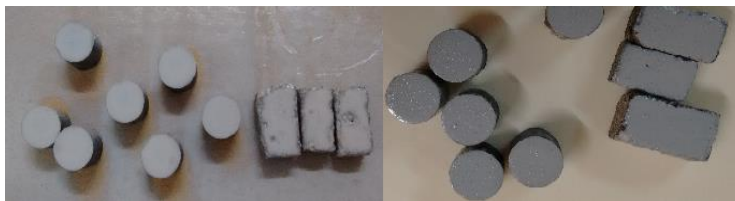
Figura 4 – Corpos de prova com a tinta padrão x tinta teste.
