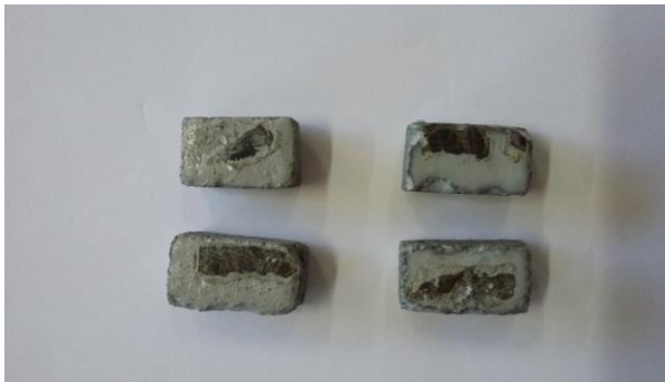
Figura 7 – Foto dos CPs de concreto após o ensaio de desgaste (Os CPs da esquerda são de sílica e os da direita de quartzo).
