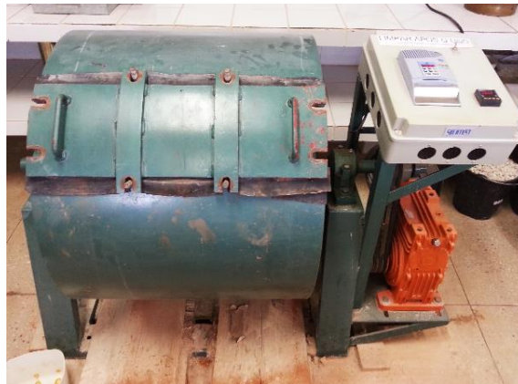
Figura 1. Aparelho de Ensaio de Abrasão de Los Angeles.
