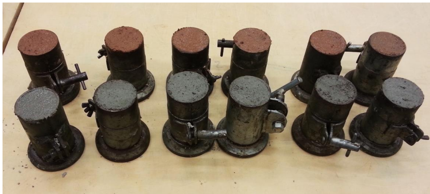
Figura 3. Moldagem dos corpos de prova.
