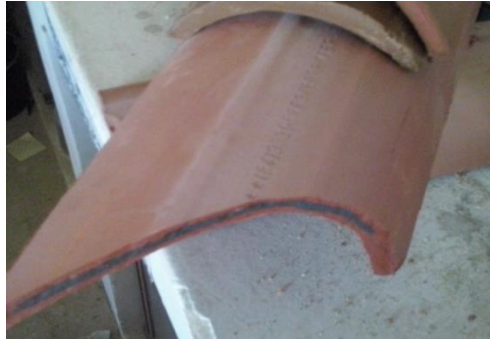
Figura 3 - Coração negro na telha de primeira linha.
