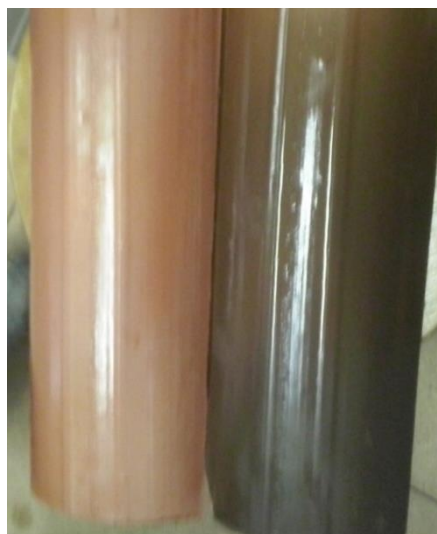
Figura 6 - Telhas de primeira e segunda linha após submersão.
