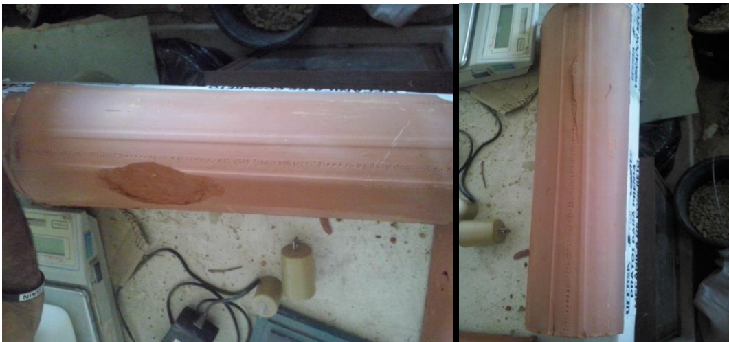
Figura 2 - Telhas de terceira linha, amostra 1 e 2, respectivamente.
