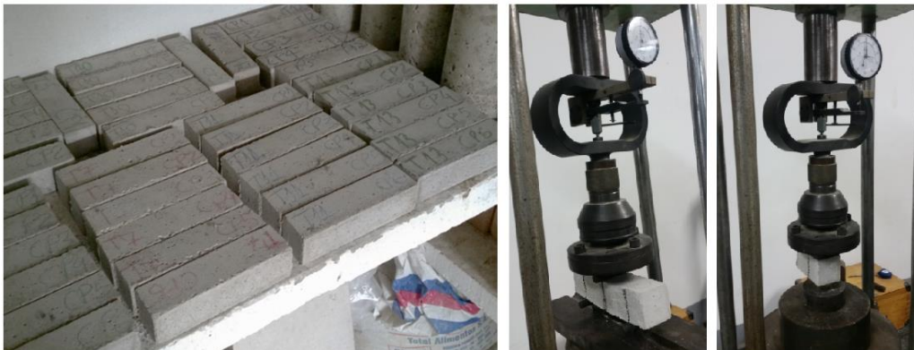
Figura 1: Determinação da resistência à tração na flexão e à compressão das argamassas com corpos de prova prismáticos.
