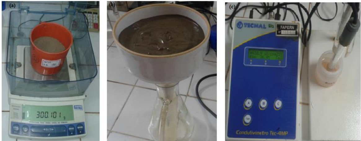
Figura 1: (a) Balança de precisão com material a ser pesado. (b) Pasta de saturação no funil de Buckner . (c) Verificação da condutividade elétrica no meio aquoso.
