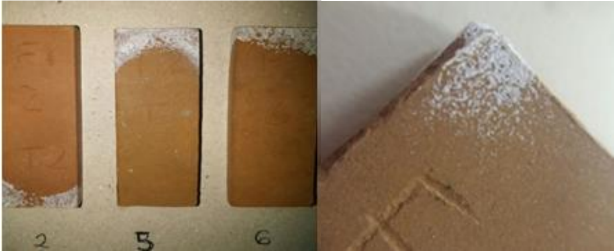
Figuras 3 e 4. Eflorescência formada nos corpos de prova com o rejeito de Pó de Despoeiramento.
