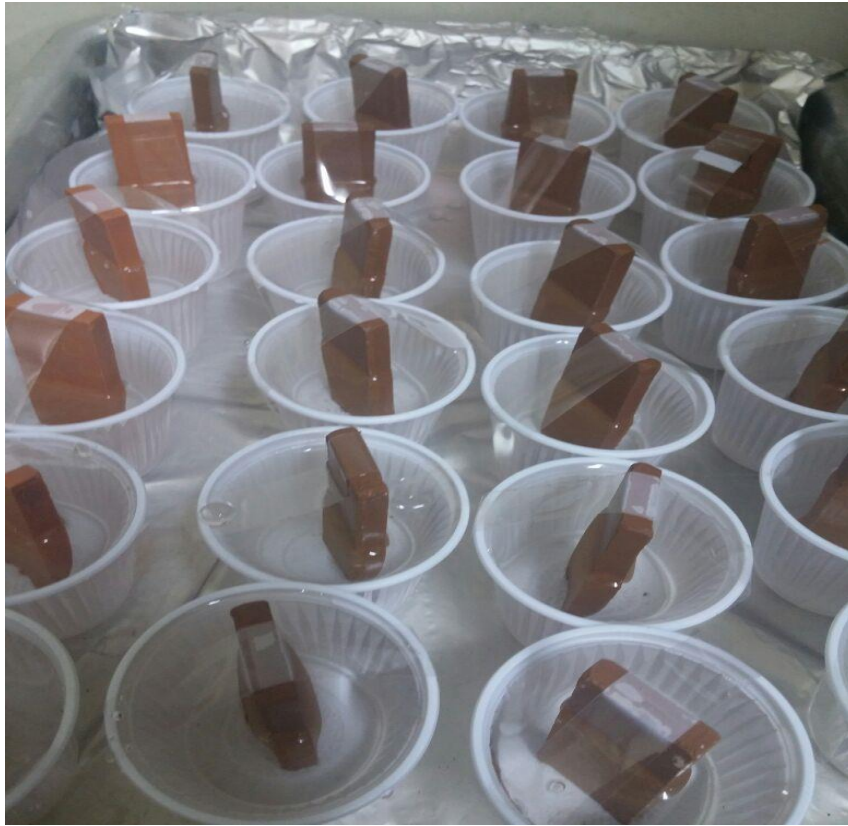
Figura 2. Imersão dos corpos de prova como parte do ensaio de efluorescência.
