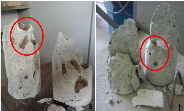
Figura 3 (a): Rompimento dos Corpos de Prova 7 dias - 1º lote; (b): Rompimento dos Corpos de Prova 28 dias - 1º lote. Fonte: Arquivo pessoal (2014). [Figure 3 (a): Disruption of Match Bodies 7 days - 1st batch; (b): Disruption of the Match Bodies of 28 days - 1st lot. Source: Personal File (2014)].
