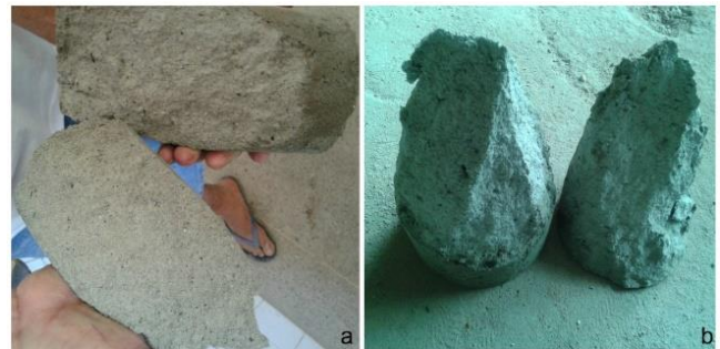
Figura 5 (a): Rompimento dos Corpos de Prova 7 dias - 3º lote; (b): Rompimento dos Corpos de Prova 28 dias - 3º lote. Fonte: Arquivo Pessoal (2014). [Figure 5 (a): Disruption of the Match Bodies of seven days - 3rd batch; (b): Disruption of the Match Bodies of 28 days - 3rd lot. Source: Personal Cabinet (2014)]
