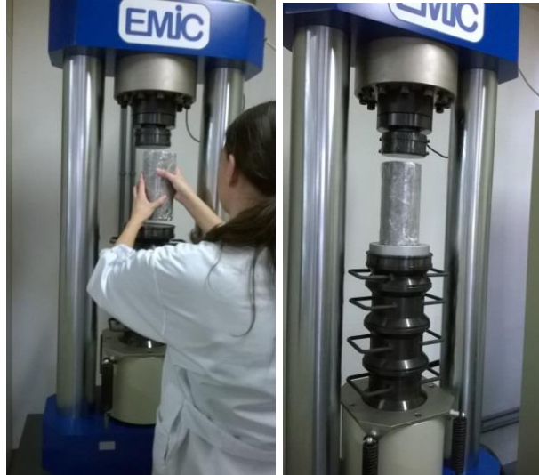
Figura 03 - Execução do ensaio de compressão do concreto
