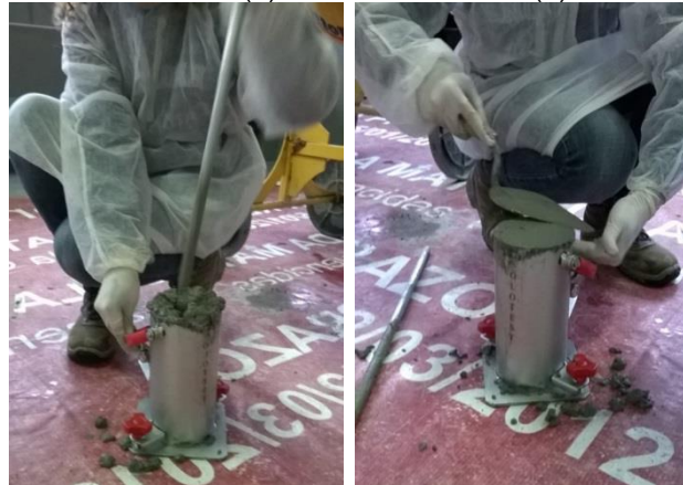
Figura 02 - Moldagem corpos-de-prova (a) com adensamento manual (b) com rasamento
