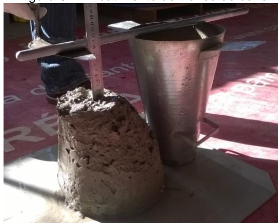
Figura 01 – Abatimento de tronco de cone
