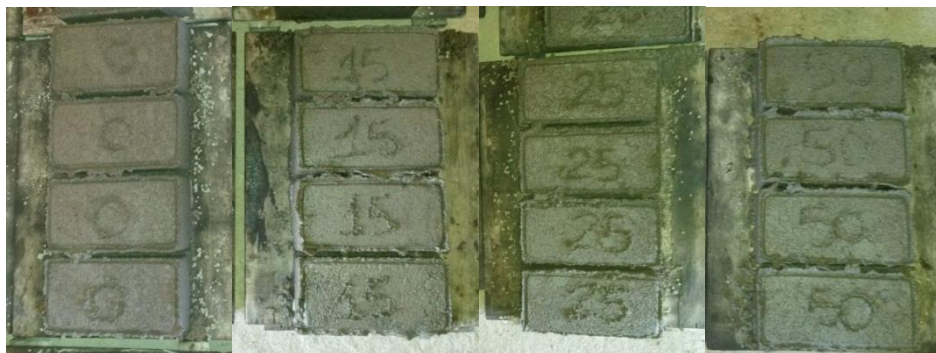
Figura 1: Blocos intertravados produzidos de (0%, 15%, 25% e 50 % de pó de pedra). Fonte: Autor (2016).
