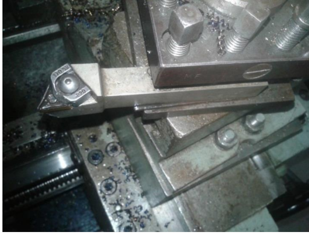
Figura 2: Ferramenta com inserto (T) acoplado
