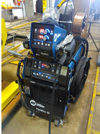
Figura 2 – Máquina de solda RMD® PipeWorx 400
