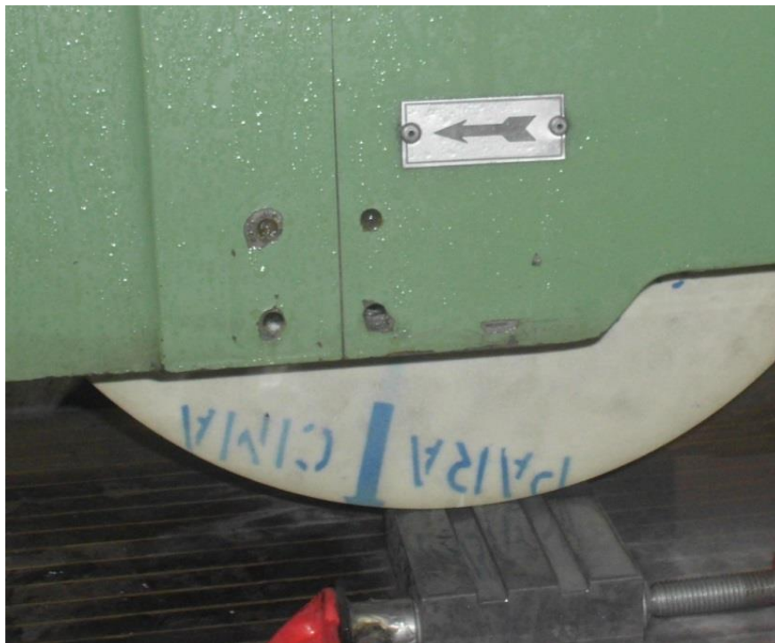
Figura 2 – Ensaio de retificação plana do aço endurecido ABNT 4340.
