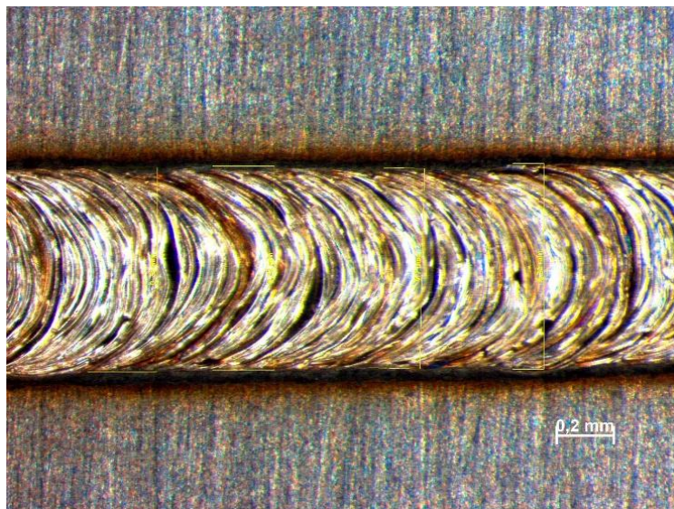
Figura 2. Vista superior do cordão de solda obtido por laser pulsado de Nd:YAG. Fonte:
