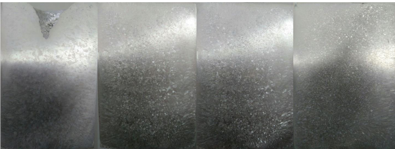
Figura 6 a, b, c, d, respectivamente. Liga Al-0,35%Si-0,40%Mg solidificadas a 0 Mpa, 50 MPa, 100 MPa e 150 MPa, nesta ordem.
