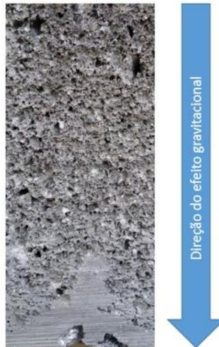
Figura 2 – Direção do efeito gravitacional sobre a amostra.
