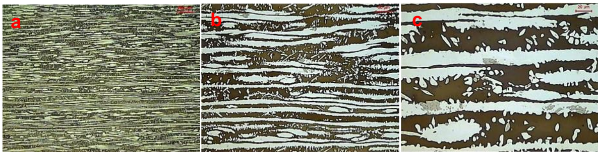
Figura 2 - Micrografia do estado entrega com diferentes aumentos. (a) MO – 50x; (b) MO – 200x; (c) MO – 500x. Ataque Behara II.
