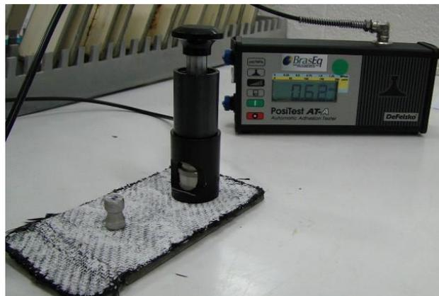
Fig. 2: Montagem do ensaio de *Pull-Off* segundo a norma ASTM 4541<sup>[5]</sup>.
