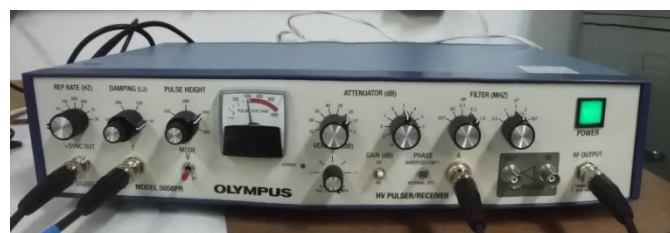
Figura 3 - Gerador de pulsos Ultrassônicos Olympus NDT modelo 5058PR.
