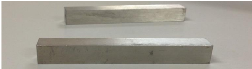
Figura 1 - Amostras de aço UNS30409 após usinagem.
