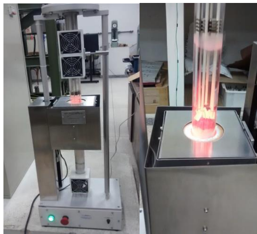
Figura 3: Forno de ensaio de oxidação cíclica. À esquerda, posição alta, e à direita, posição baixa.
