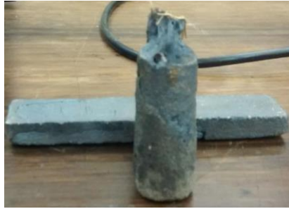
Figura 1: Liga fundida em molde de areia.
