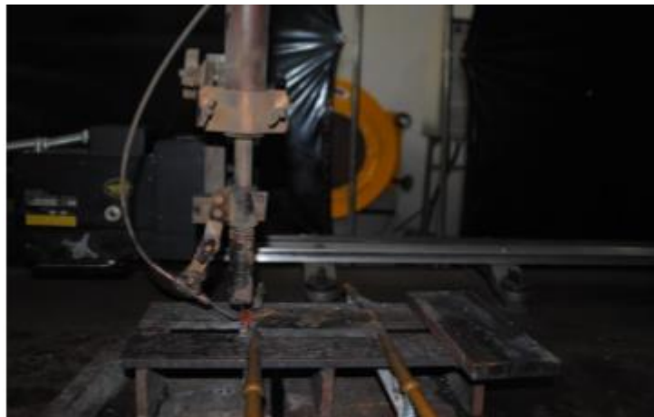
Figura 3– Bancada preparada para execução da soldagem GMAW-CW
