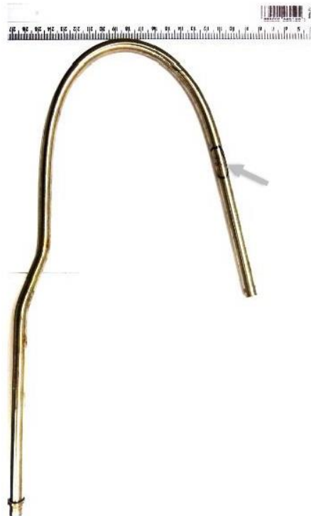
Figura 1: Tubo como recebido. Ponto de vazamento circulado e indicado com seta.
