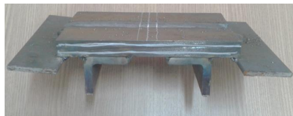
Figura 4 – Chapas restringida mostrando na parte inferior as cantoneiras de ancoragem e nas laterais as chapas de início e fim da soldagem
