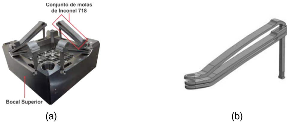
Figura 1- Bocal superior do ECN: (a) conjuntos das molas de sustentação e (b) detalhe de montagem das molas.
