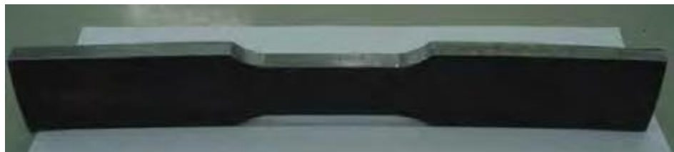
Figura 2 – Corpo de prova de tração retirado diretamente da parede do tubo.
