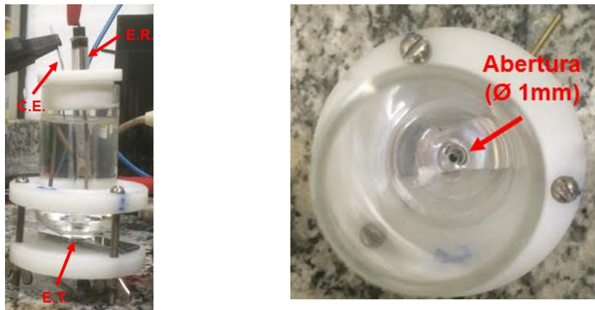
Figura 1: Fotografias da célula eletroquímica com o-ring de 1,0 mm de diâmetro, utilizada nos ensaios das diferentes zonas formadas pela solda por FSW.
