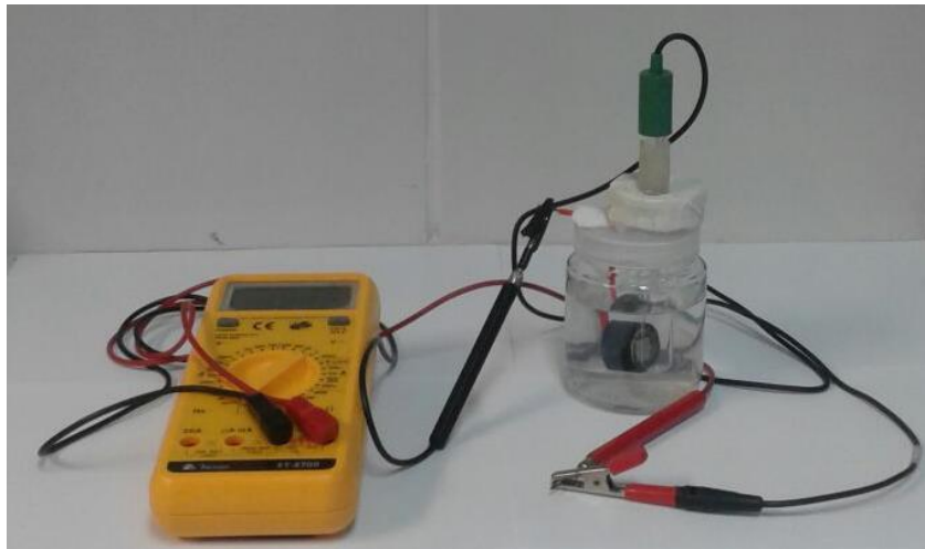
Figura 3. Sistema experimental para medida do potencial de circuito aberto.
