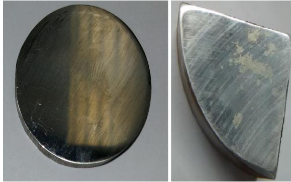
Figura 2 - Amostras dos Aços AISI 316 L e 303 depois da exposição à solução de água do mar
