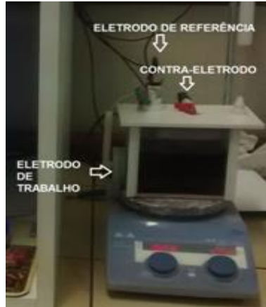
Figura 1 – Célula eletrolítica de três eletrodos utilizada nos ensaios
