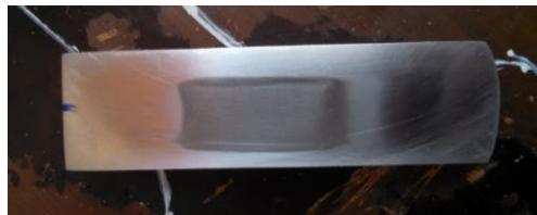
Figura 10 - Marca uniforme de desgaste.
