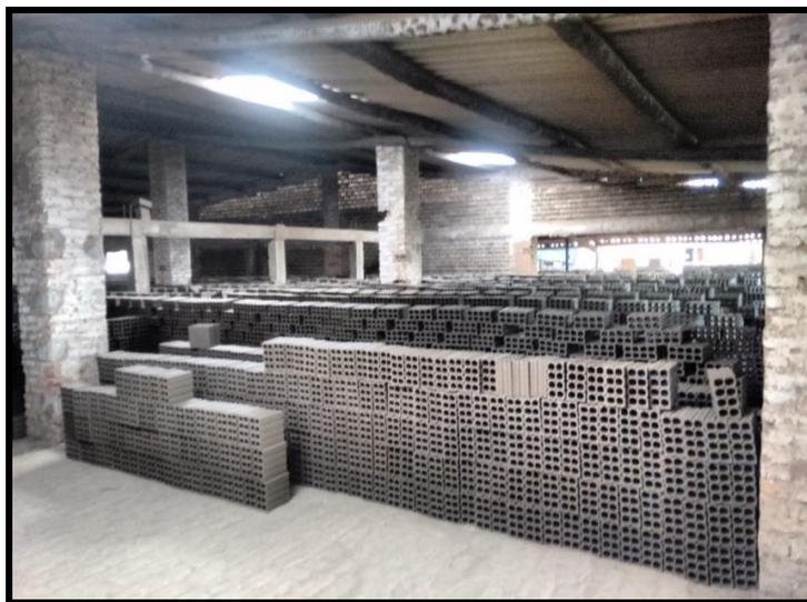
**Figura 4.** Secagem do tijolo na cerâmica Pataxó
