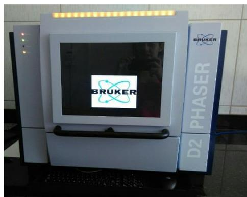
**Figura 3** - Difratômetro de raios X BRUKER (modelo D2 PHASER, radiação Cu-K $\alpha$ ).
