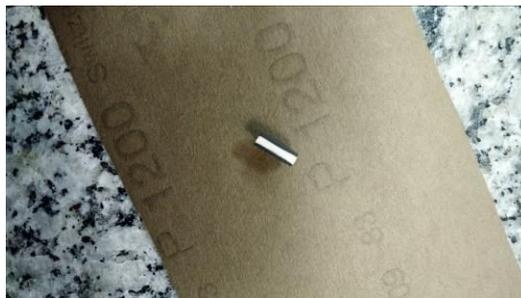
Figura 8: Célula simétrica analisada evidenciando as 3 camadas (eletrodo/eletrólito/eletrodo).
