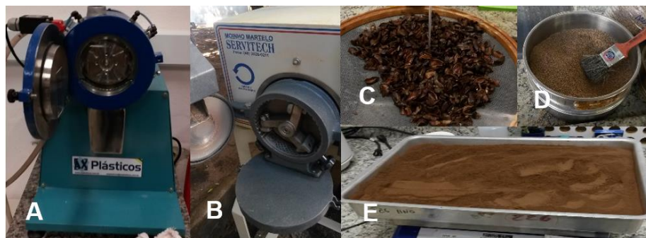
Figura 2: A) Moinho de facas; B) moinho de martelo; C) Lavagens das cascas da semente; D) Peneiramento das cascas moídas; E) Cascas moídas, separadas granulometricamente e secas para serem usadas nos compósitos com PP.
