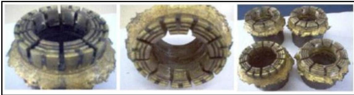
Figura 4 - Amostras das coroas de perfuração produzidas, por indução eletromagnética, segundo os parâmetros da amostra 9.
