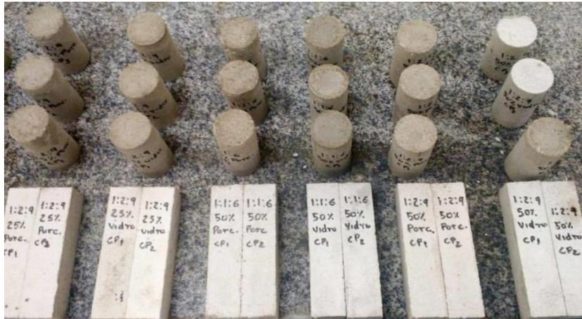
FIGURA 01: Corpos de prova moldados para o ensaio mecânico.
