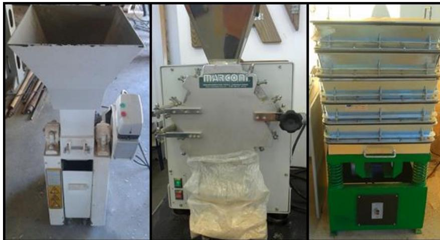
Figura 1: Equipamentos para adequação e preparo das partículas: (a) Picador; (b) Moinho; (c) Agitador.
