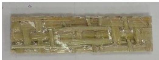
Figura 9 - Corpo de prova de fibra de carnaúba antes do ensaio de tração
