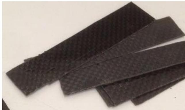
**Figura 11 - Corpos de prova de fibra de carbono antes do ensaio de flexão**
